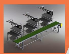
Este sistema permite la automatización y monitoreo industrial de bandas transportadoras en líneas de ensamble; se trata de un simulador que permite realizar estudios de tiempos y movimientos, en ambientes controlados, con el fin de balancear las líneas de ensamble, así como de hacer comparaciones de equipos de control de bandas transportadoras en líneas de ensamble.
