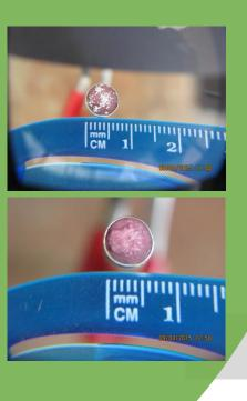
Este procedimiento sirve para preparar polímeros (fosforilados) tipo hidrogel, con capacidad de hincharse en intervalos de 700-2600% en medios de pH 7.2. Esta propiedad los hace susceptibles de utilizarse en la Industria Farmacéutica; para elaborar medicamentos de liberación controlada, donde el fármaco tenga baja solubilidad como es la tolbutamida o la indometacina entre otros.
