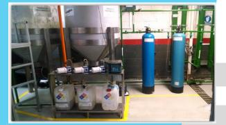
Este desarrollo consta de un método y planta alternativos para tratar aguas con grasas e hidrocarburos. El sistema se compone por procesos de coagulación y floculación para los agentes contaminantes, los cuales se encuentran en las aguas residuales de ciertas industrias y sectores.
