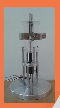
Este es un biorreactor modular para el cultivo de células animales con sistemas de estimulación mecánica, eléctrica y de perfusión mejorados, que incluye sistema de control, de monitoreo y de oxigenación externos. Puede ser utilizado en diversas aplicaciones en ingeniería de tejidos, regeneración o reparación de tejidos animales y humanos.
